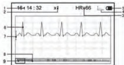
Abb. 3-13A EKG-Anzeige bei Datenwiederaufruf (Schnellmessung)
